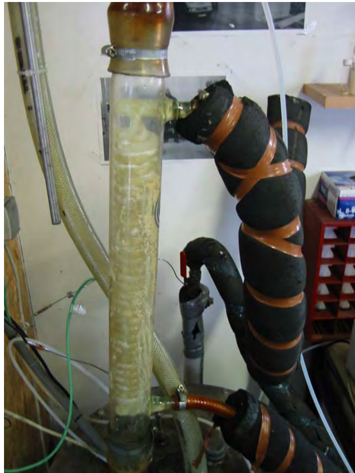
Abbildung 3.12: Glaswärmetauscher mit Doppelwendel
