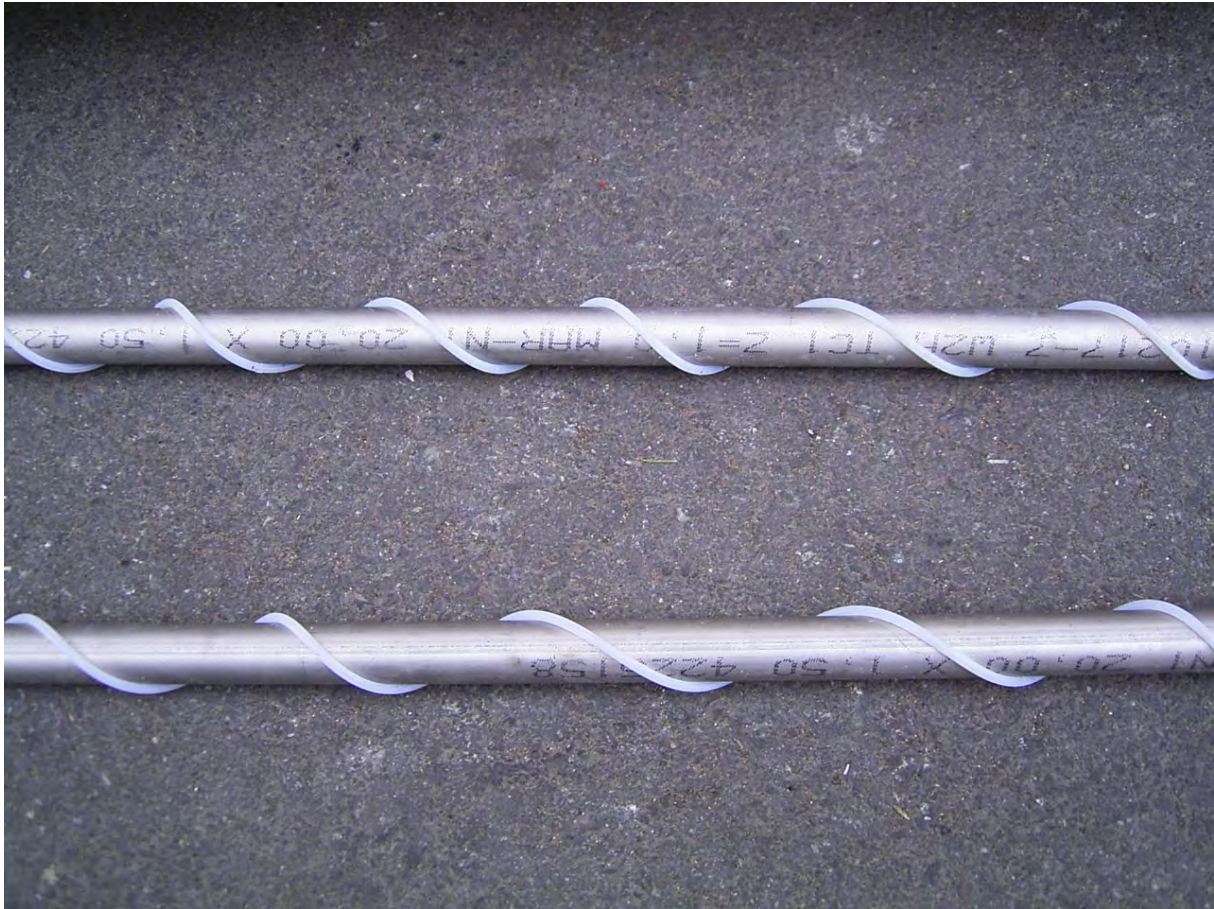
Abbildung 3.14: Kernrohre mit Teflonschlauch-Turbulatoren
